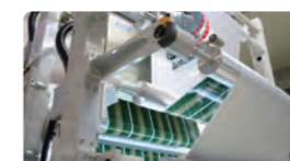
印刷ミスや異物混入を 自動で高速に探知する 印刷品質検査装置
