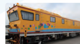
超音波でレール内部の傷を 検知する超音波レール探傷車
