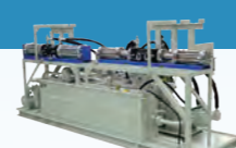
水素ステーション向け 油圧式水素圧縮装置
