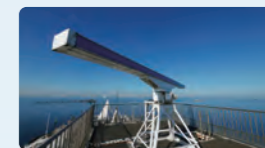
船舶通航管理システムに 使用される海上監視レーダー
